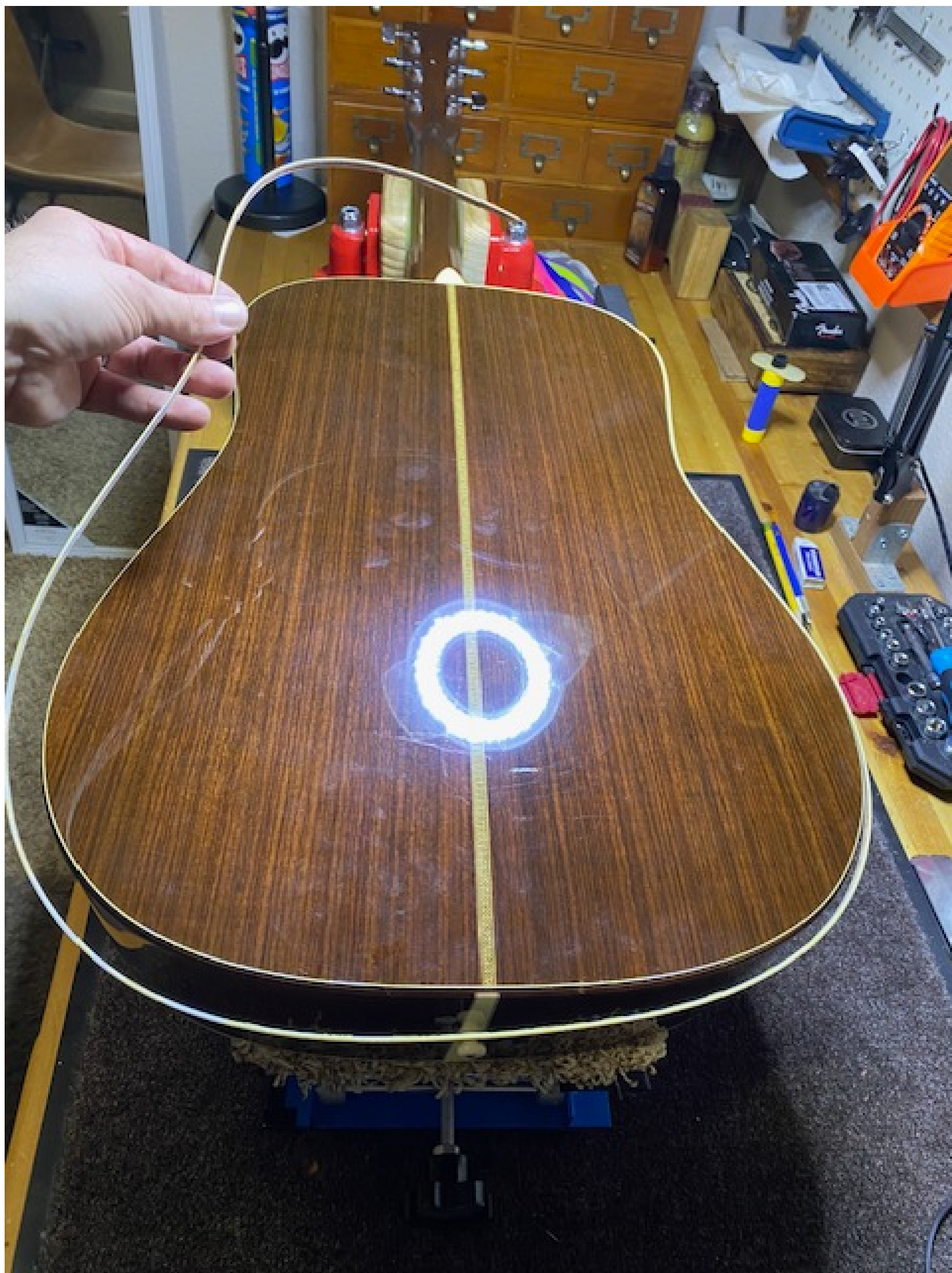
Martin D28 binding repair no1
